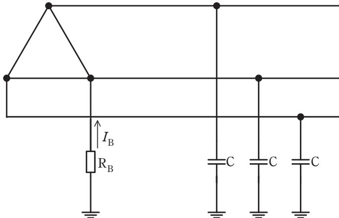
(a) 変圧器に施された、接地抵抗  $R_B$  の抵抗値について「電気設備技術基準の解釈」で許容されている上限の抵抗値 $[\Omega]$ として、最も近いものを次の(1)～(5)のうちから一つ選べ。
