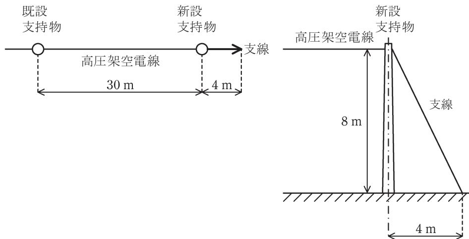
(a) 電線の水平張力が 15 kN であり、その張力を支線で全て支えるものとしたとき、支線に生じる引張荷重の値 [kN] として、最も近いものを次の(1)～(5)のうちから一つ選べ。
