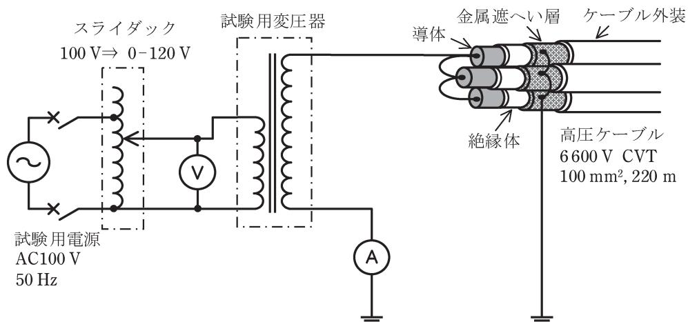
この絶縁耐力試験に必要な皮相電力の値 [kV·A] として、最も近いものを次の(1)～(5)のうちから一つ選べ。
