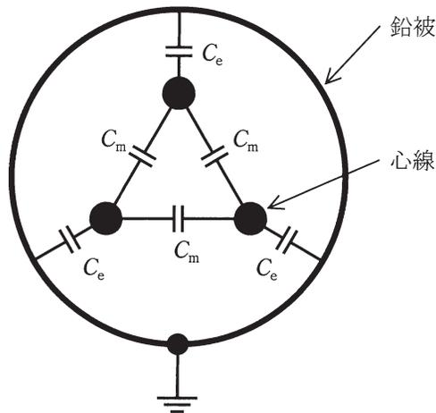
(a) 対地静電容量  $C_e$ [F]と線間静電容量  $C_m$ [F]の比  $\frac{C_e}{C_m}$ として、最も近いものを次の(1)～(5)のうちから一つ選べ。
