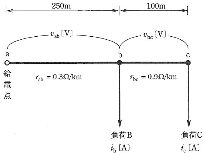
(a)  $b - c$  間の 1 線の電圧降下  $v_{bc} \text{ [V]}$  及び負荷 B と負荷 C の負荷電流  $i_b, i_c \text{ [A]}$  として、正しいものを組み合わせたのは次のうちどれか。
